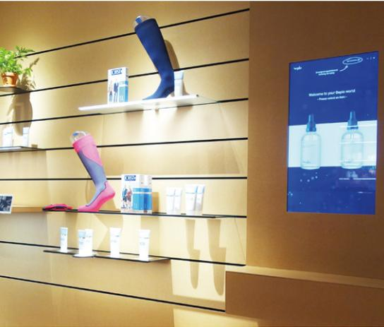
**8** In diesem elektrifizierten Warenträgersystem können Informationen zu Preis und Inhalt des Produkts auf elektronischen Labels (ESL) dargestellt werden. Die eingeklickten Fachböden leuchten mittels eines LED-Lichtbands nach unten. Auf dem Bedienerportal (Bildschirm rechts) können sich Kunden selbst über die Verfügbarkeit einer Behandlungskabine inklusive Mitarbeiterin erkundigen oder sich für einen Behandlungstermin einbuchen.
